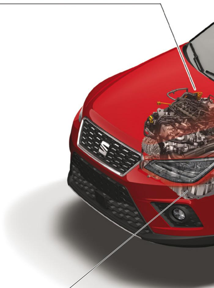
Calculateur du capteur de NOx J583 (forme une seule pièce avec le capteur de NOx G295)
