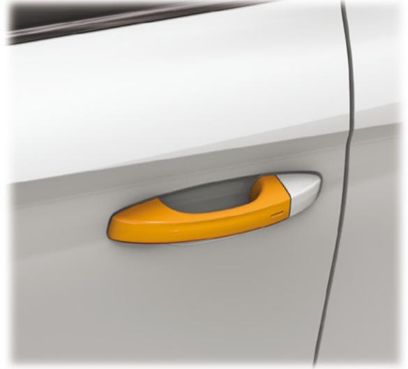
Capteur d'effleurement de la poignée extérieure de la porte avant gauche G605
