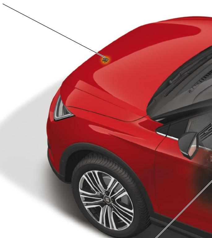
Capteur de collision de l'airbag latéral côté conducteur G179
