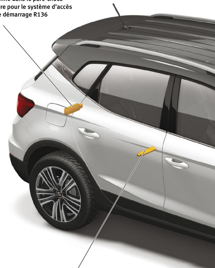
Antenne 2 dans l'habitacle pour le système d'accès et de démarrage **R139**
